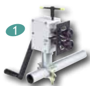
Réf. SB3M équipée du support d'échafaudage (en standard sur SB3M, Ø mini-maxi : 45-49 mm)
