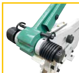
Sécurité : ressort de rappel sur la lame supérieure
