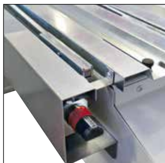
Pliage conique, réglage manuel
