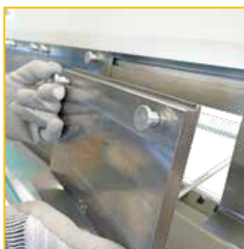
1 Démontage rapide des segments par tirette
