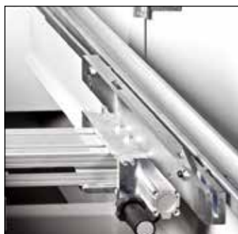
Pliage conique pneumatique, réglage manuel
