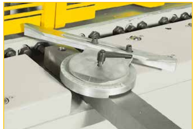
❽ Butée à angle variable
