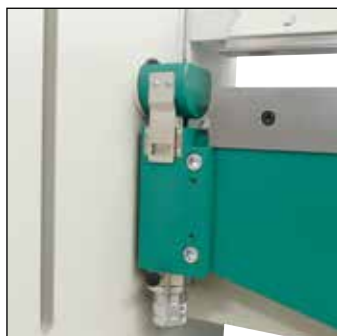
Réglage du rayon de pliage
