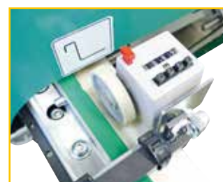
2 Programmateur de longueur électromécanique
