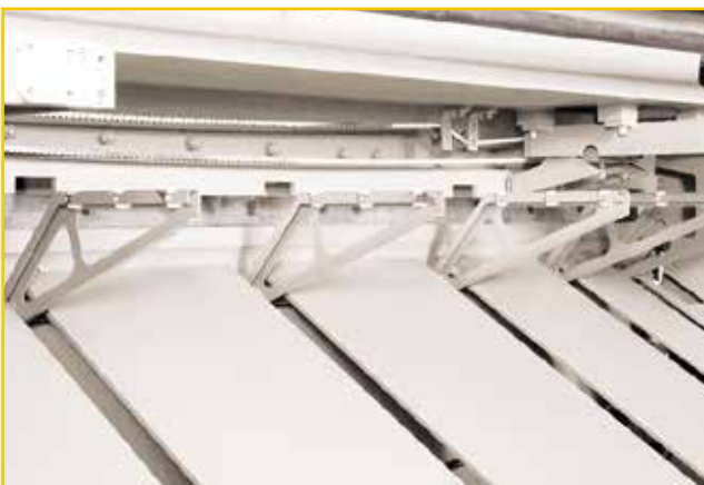
❼ Peigne soutien de tôle pneumatique
