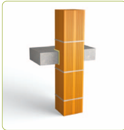
Traversée des planchers et toitures. Pour les boisseaux d'une hauteur supérieure à 25 cm : pas de joint dans la traversée des planchers. Lors de l'élévation du conduit, laisser un joint de dilatation de 15 mm minimum au droit des planchers.
