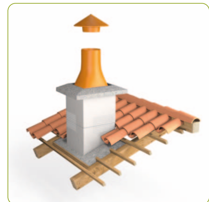
Distance de sécurité. Distance minimum entre l'extérieur du boisseau et un matériaux combustible : • Boisseau alvéolé : 10 cm • Boisseau KALISOL : 5 cm • Boisseau Isotherm : 2 cm
